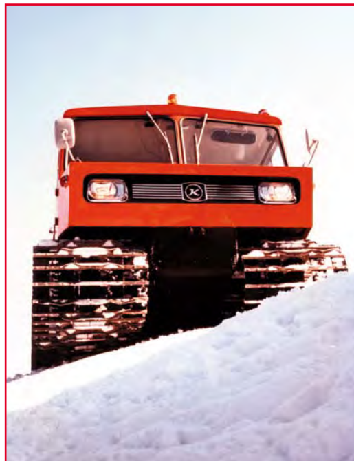
Kässbohrer snežné vozidlo – KSM 001. Podnetná myšlienka: koncom roku 1968 sa konala testovacia jazda prvého prototypu s hydrostatickým hnacím systémom.
