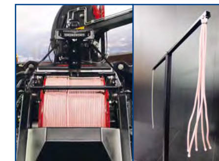
Bubon navijaka so syntetickým lanom a porovnanie hmotnosti s oceľovým lanom
