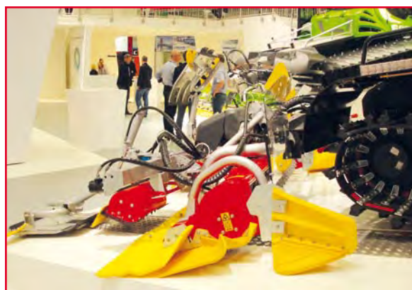
Zadná fréza verzie vozidla PB100 4F Nordic na úpravu bežeckých tratí
