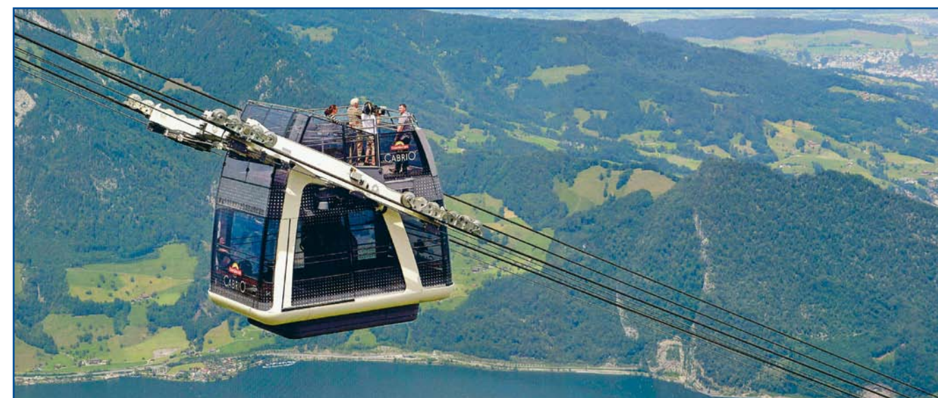
V dvojposchodových kabínach je miesto pre 60 osôb, z ktorých 30 môže stáť na vrchnom poschodí. Vďaka presklenej stene kabíny si aj deti a vozičkári môžu užiť pohľad na štyritisíc metrov vysoké vrchy v srdci Švajčiarska
